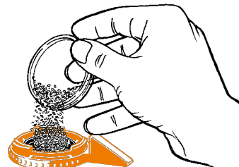
Komorę wlewową należy zawsze napełniać do pełna do górnej krawędzi
