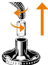
Ziehen Sie die Kühlspirale aus dem Füllkammerdeckel
