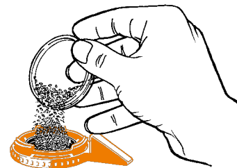
Plnicí komoru vždy naplňte až po okraj k hornímu okraji
