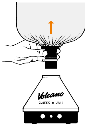
Usunąć balonik zaworu z komorą napełniania
