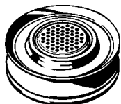
Kapsuła dozująca włożona do komory napelniania Reduktor
