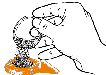
Plniacu komoru vždy úplne naplňte k hornému okraju
